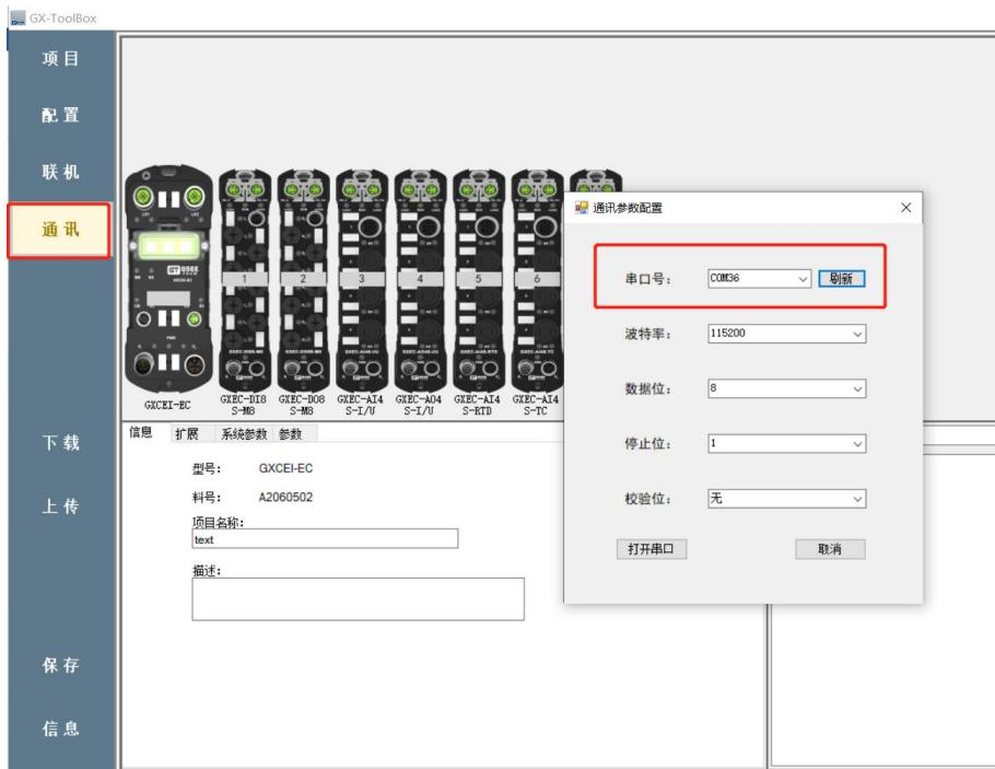
点击“打开串口”，软件状态栏中显示“命令操作完成”，表示电脑与网关已建立连接
